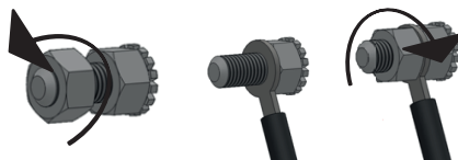
Připojení spotřebiče k systému vyrovnání potenciálů.
