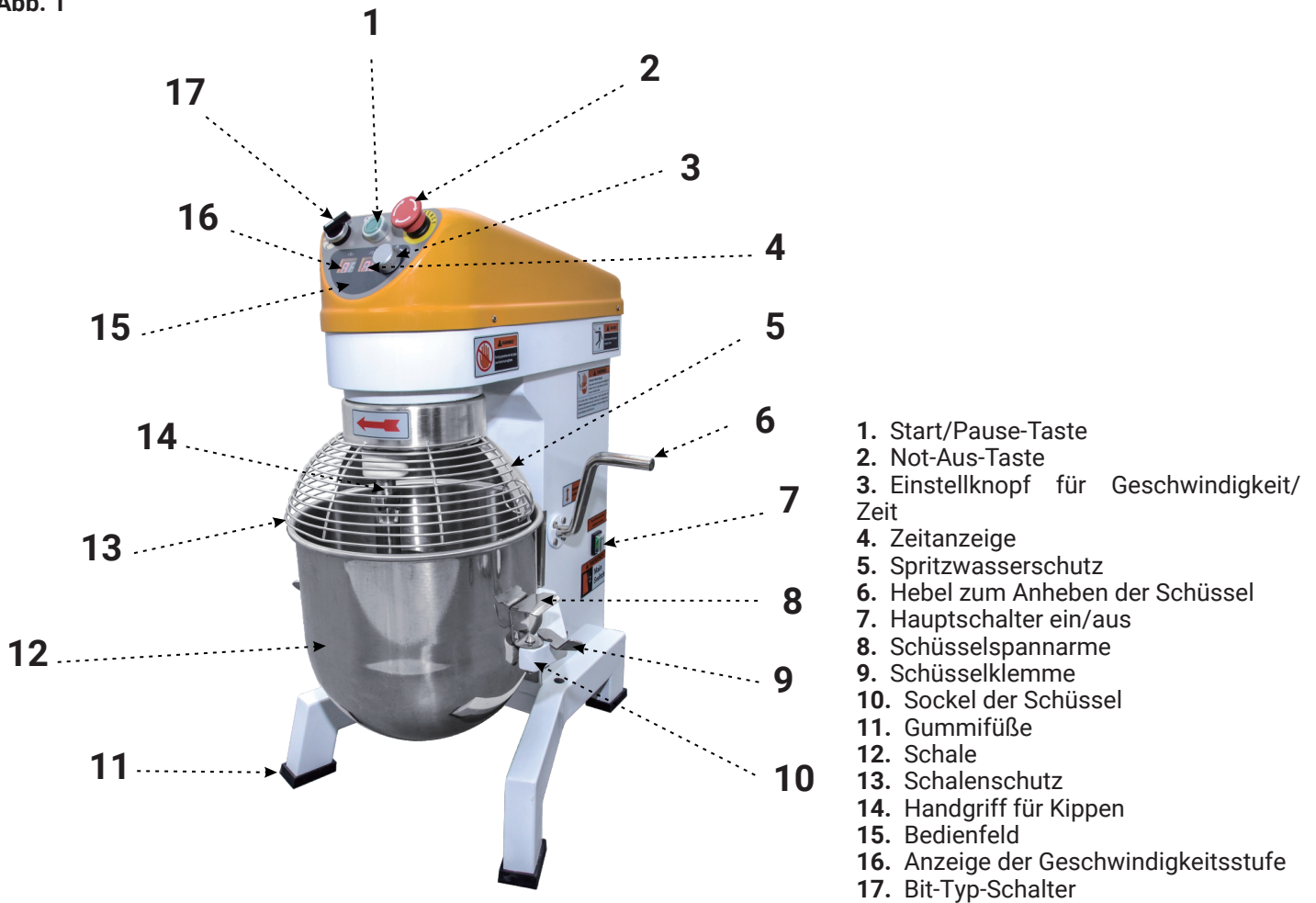
Abbildung 1 Aufbau des Geräts
