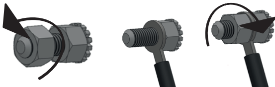
Rys. 4. Podłączenie urządzenia do instalacji wyrównującej potencjały elektryczne.
